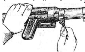
16-сурет. Бұзғыш механизмнің бұрандалы түтігін бұрап босату
