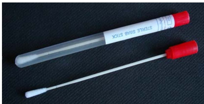
Рис. 7. Зонд в тубусе с полимерным и хлопковым стержнем или синтетическим наконечником
