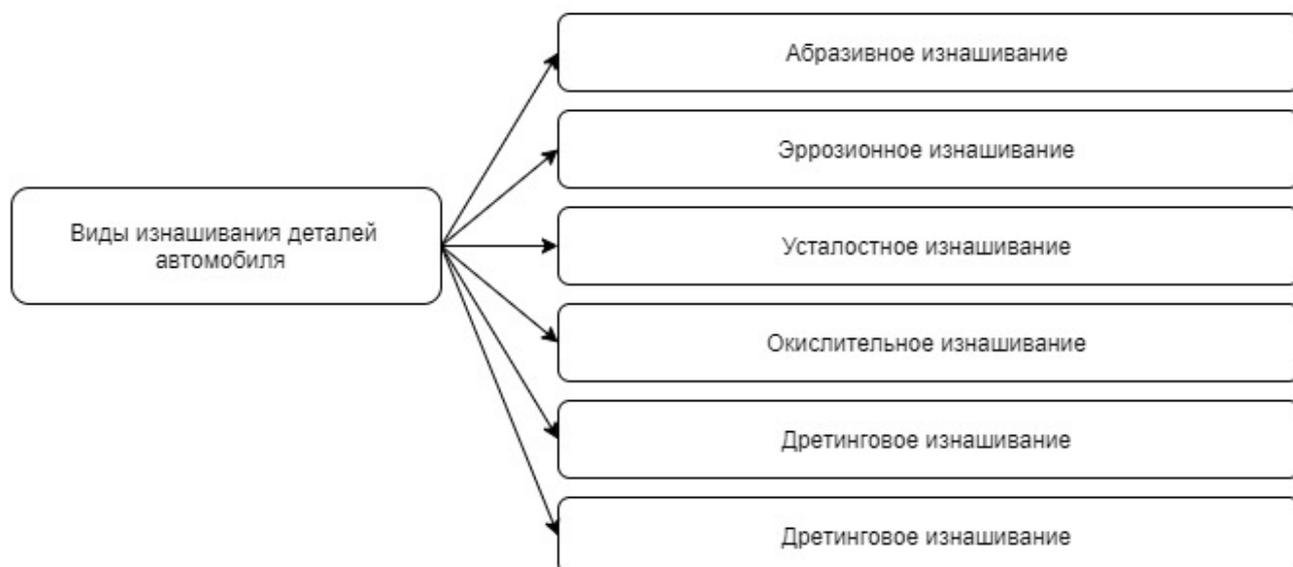
*Рис. 10. Виды изнашивания деталей автомобиля*
