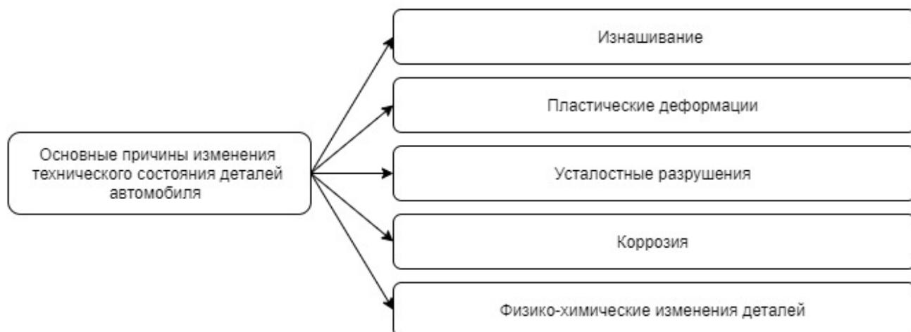
*Рис. 9. Основные причины изменения технического состояния деталей автомобиля*
