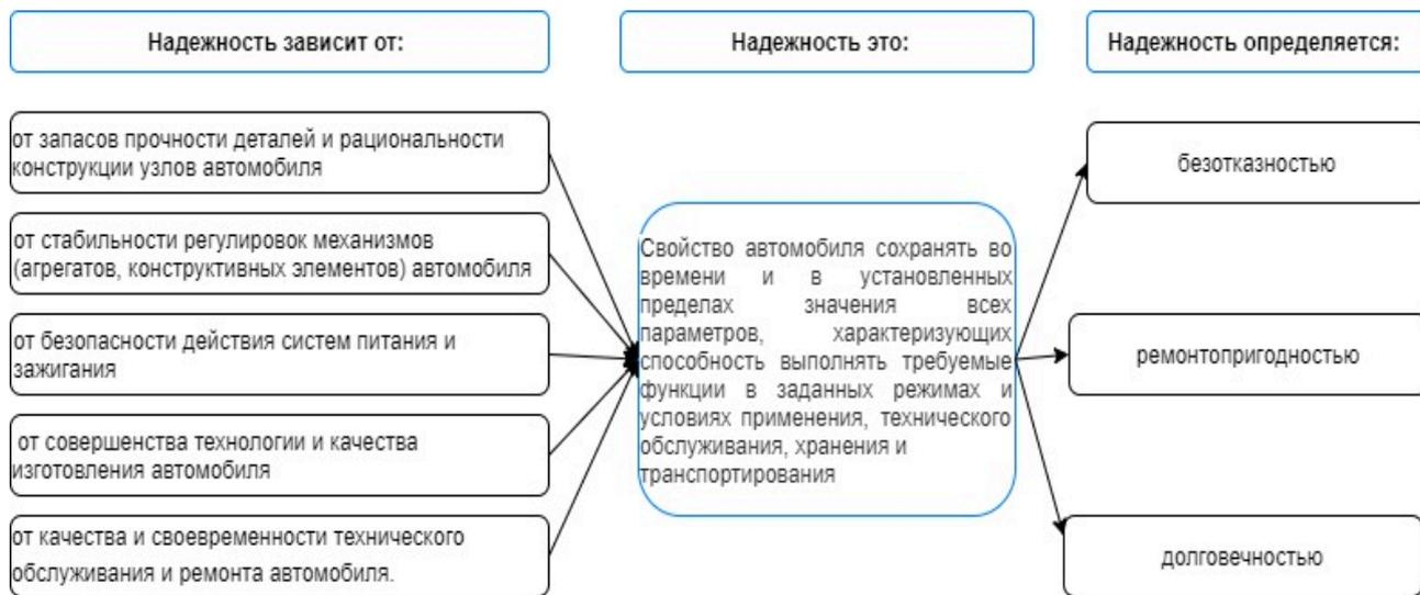
Рис. 7. Предпосылки и признаки надежности автомобиля
