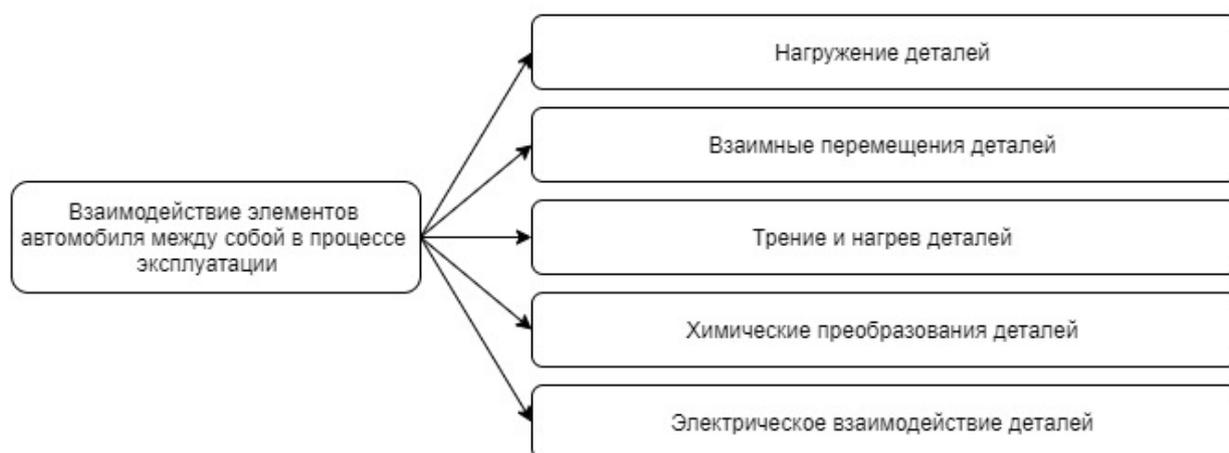
*Рис. 8. Взаимодействие элементов автомобиля между собой в процессе эксплуатации*
