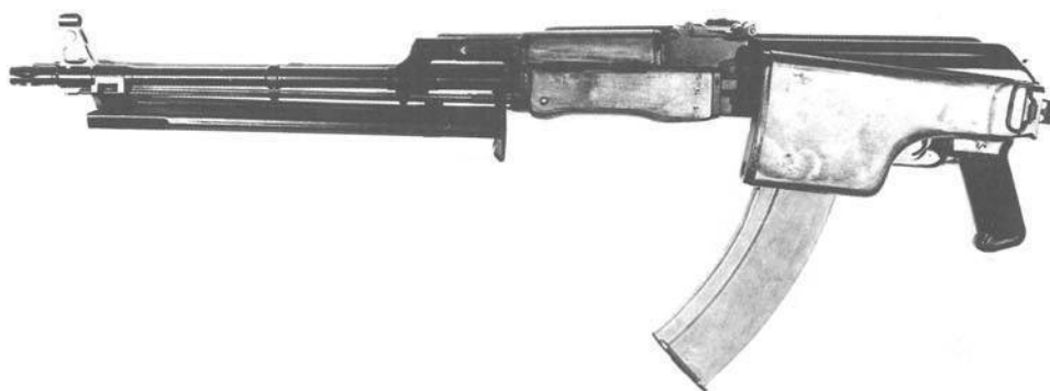
Калашников қол пулеметі жиналмалы дүмімен 74 - СКҚП (РПКС-74) 1974 жж
