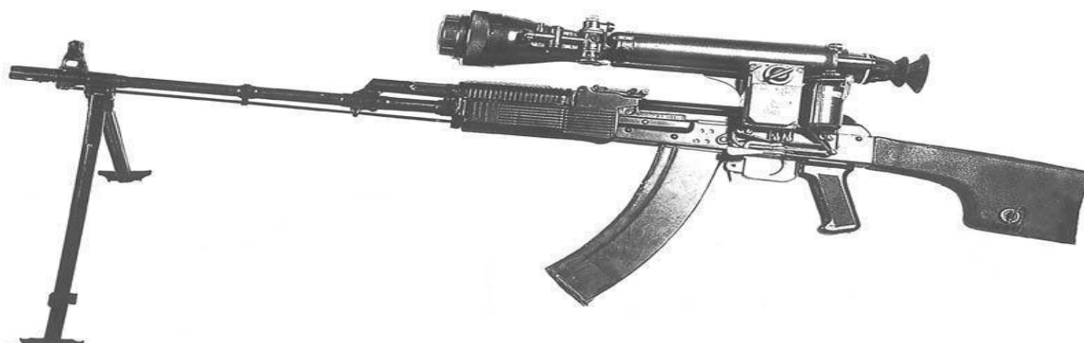
Калашников қол пулеметі Т74-СКҚП (РПКС-74Н) 1974 ж түнгі көздеуіші және тіреуіш сирақтарымен.
