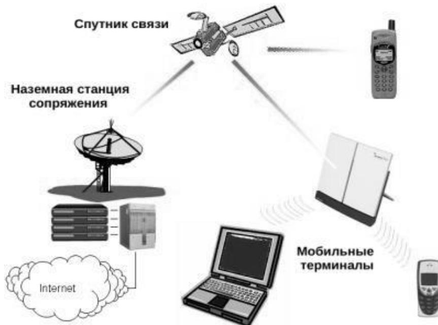
Рис.4.4. Структурная схема спутниковой системы связи
