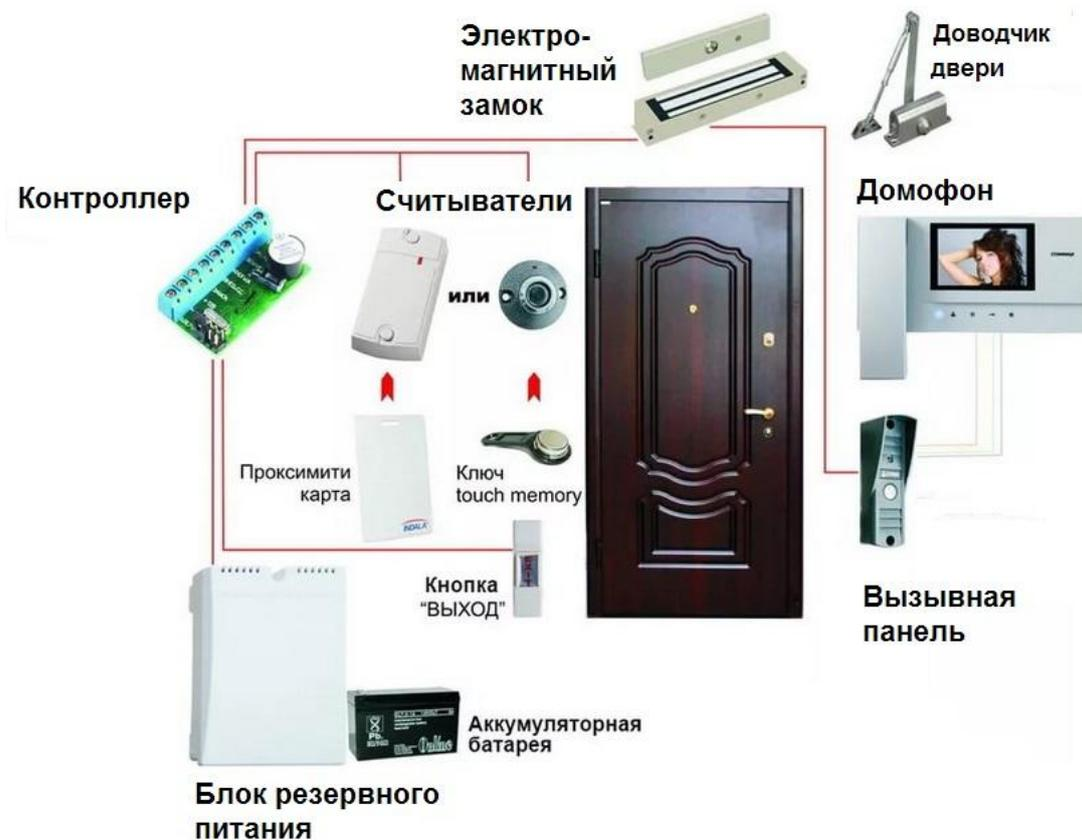
Рис. 5.2. Схема автономной СКУД
