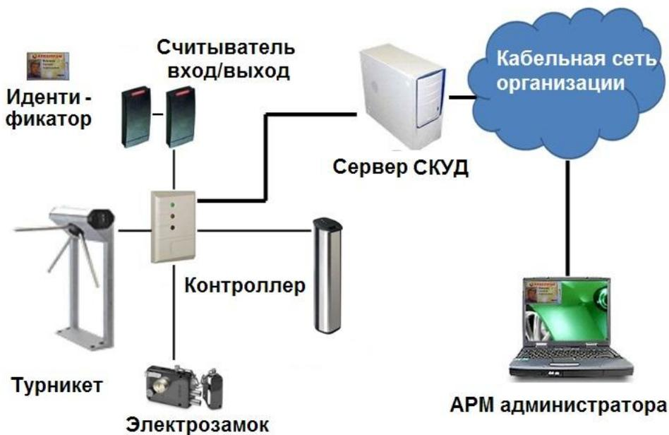
Рис. 5.3. Схема сетевой СКУД
