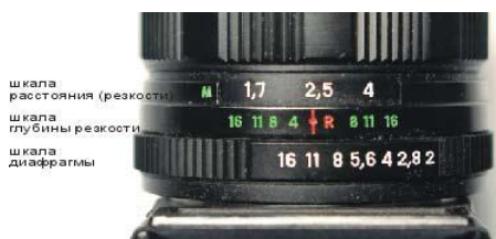
Рис. 13. Определение глубины резкости изображения по соответствующей шкале объектива
