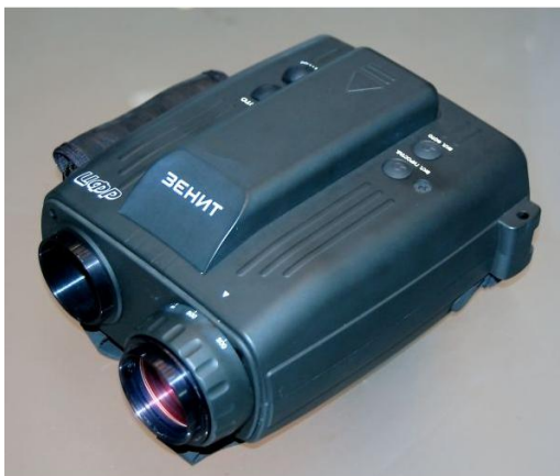
Рис. 4. Бинокль «Зенит ЦФР» совмещенный с фотокамерой 5 мегапикселей (16-кратное увеличение)
