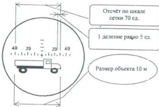
Рис. 2. Определение дальности до объекта по угломерной шкале
