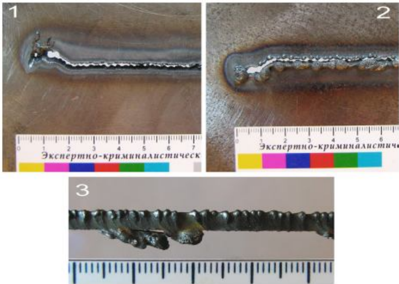
Рис. 29. След, образованный аппаратом плазменной резки «Мультиплаз-2500М» в режиме дуги прямого действия на стальном листе марки «Сталь-3» толщиной 3 мм: 1 – лицевая сторона листа; 2 – оборотная сторона листа; 3 – торцевая поверхность листа
