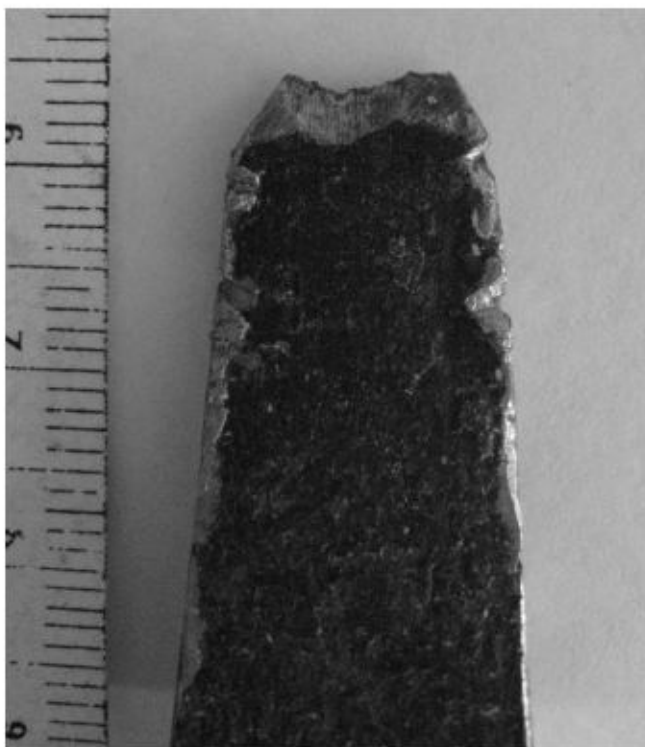
Фото 5 Рабочая часть монтировки, поступившей на исследование
