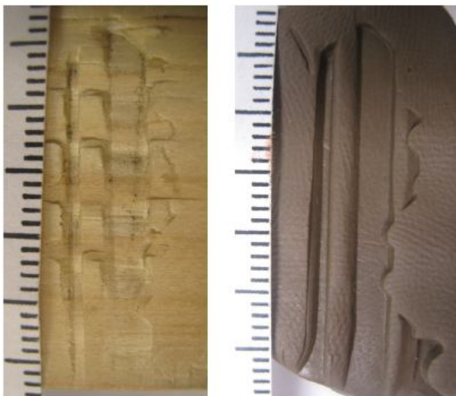
Рис. 5. След, изъятый при осмотре места происшествия (слева), и экспериментальный след орудия взлома (справа)
