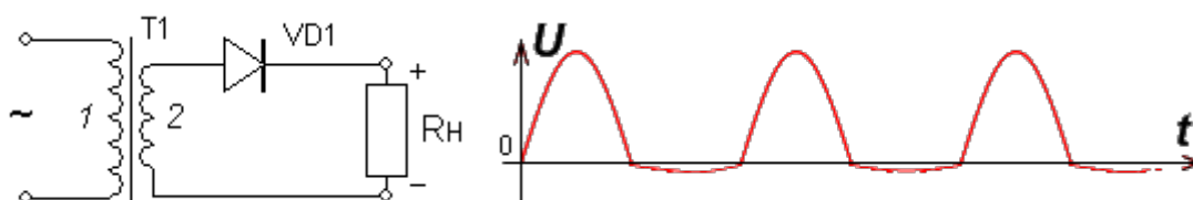
Рис. 1.3. Схема и временная диаграмма выпрямления напряжения однофазным однополупериодным выпрямителем (прямое включение)
