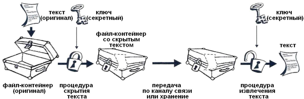
Рис. 11. Схема стеганографического преобразования при тайной передаче сообщения по компьютерной сети
