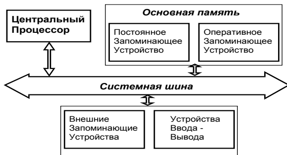
Рис. 1. Обобщенная структурная схема компьютера
