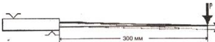
Рис. 15. Схема проведения испытаний на прочность и упругость кинжалов, предназначенных для ношения с национальными костюмами народов Республики Казахстан
