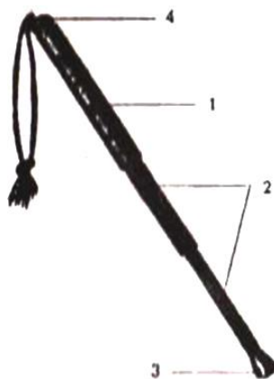
Рис. 8. Складной кистень: 1 - полая цилиндрическая рукоять; 2 - пружинный подвес; 3 - ударная часть; 4 - заглушка
