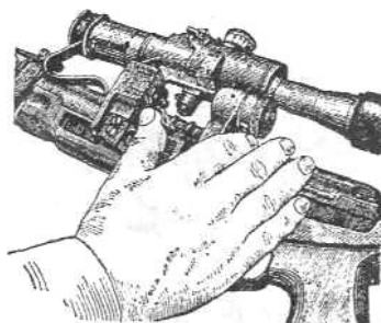
17-сурет. Оптикалық көздеуішті бөлшектеу.
