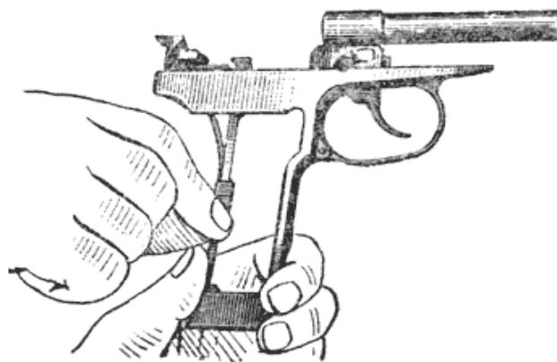
Закрепление боевой пружины задвижкой
