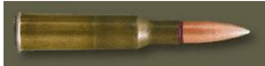
7,62x53R мм винтовочный патрон с термоупрочненным сердечником (7-Н-13)
