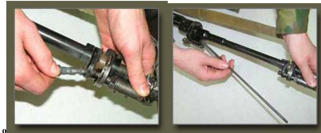
Рис. 11. Отделение газового поршня и толкателя с пружиной a — отделение газового поршня, б —
