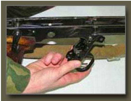
Рис. 9. Отделение ударно-спускового механизма а —отделение предохранителя, б —отделение ударно спускового механизма
