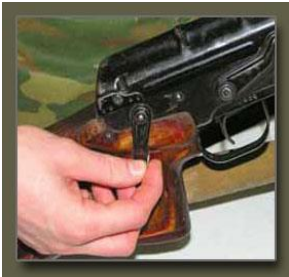
Рис. 6. Отделение крышки ствольной коробки с возвратным механизмом
