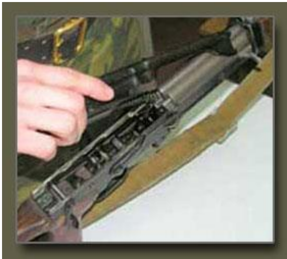
Рис. 7. Отделение затворной рамы с затвором
