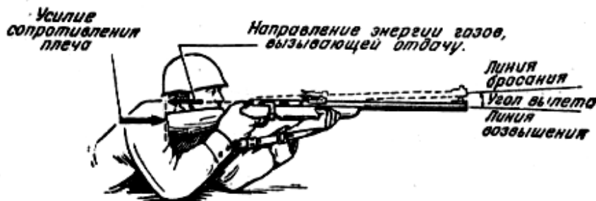
Рис. 47. Образование угла вылета
