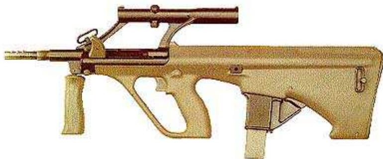
Модификация известной штурмовой винтовки - заменяются ствол, затворный блок, приемник магазина - и готов пистолет-пулемет. Все это - силами самого стрелка и менее чем за десять минут. В результате получается пистолет-пулемет, работающий по схеме со свободным затвором. ПП может оснащаться глушителем.
