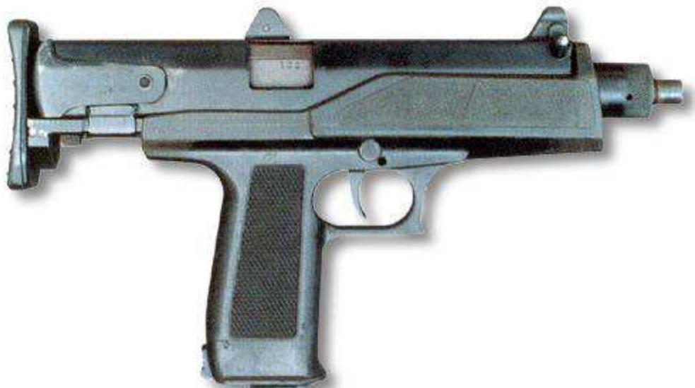
Пистолет-пулемет АЕК-919К "Каштан" разработан на Коровском Механическом заводе в середине 1990х годов. Первоначально за образец был взят австрийский ПП Steyr MPi-69, однако после выпуска малой пробной партии был обнаружен ряд недостатков, и "Каштан" был переработан. Обновленный образец получил индекс АЕК-919К, и в настоящее время активно рекламируется для вооружения экипажей боевых машин и авиатехники а также для сил спецназначения МВД и армии.
