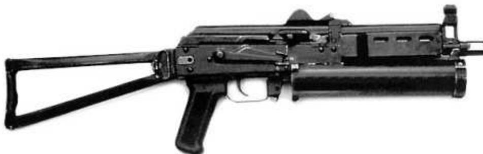
Пистолет-пулемет ПП-19 "Бизон" был разработан на Ижевском Машиностроительном заводе в начале 1990х годов для вооружения МВД. ПП-19 построен с широким использованием узлов и деталей от автомата Калашникова АК-74, в частности, используются укороченная ствольная коробка от АК-74 с ударно-спусковым механизмом и пистолетной рукояткой, складной приклад от АКС-74.
