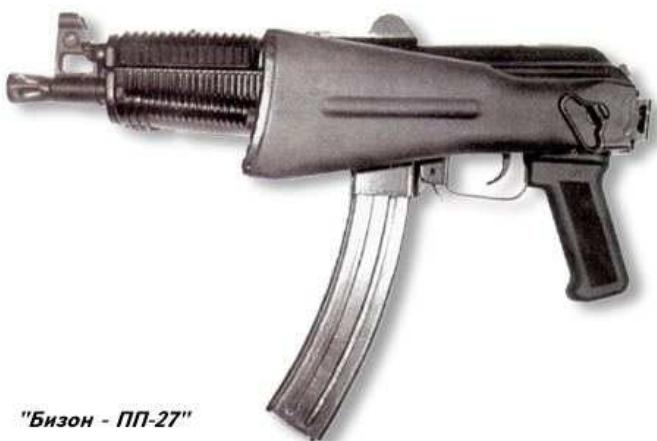
Расположение патронов в магазине по спирали и система их подачи весьма напоминает схему фирмы "Калико" Переводчик-предохранитель, рукоятка взведения и окно выброса расположены с правой стороны. Откидной приклад поворотного типа, складывается влево к ствольной коробке. Благодаря высокому темпу стрельбы и большой емкости магазина оружие позволяет создавать хорошую плотность огня на дистанции до 100 метров.
