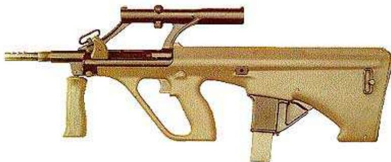
Модификация известной штурмовой винтовки - заменяются ствол, затворный блок, приемник магазина - и готов пистолет-пулемет. Все это - силами самого стрелка и менее чем за десять минут. В результате получается пистолет-пулемет, работающий по схеме со свободным затвором. ПП может оснащаться глушителем.
